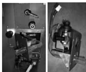
Bomba de condensados
