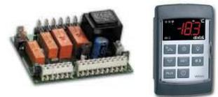
■ Placa electrónica integrada en la unidad condensadora con 6 relés de mando para: compresor, ventilador de condensación, ventilador de evaporador, desescarche, luz y alarma.
