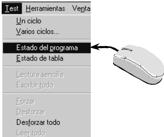
El menú **Test > Estado del programa** permite activar o desactivar la visualización del estado en Esquema de contactos.
