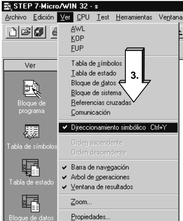
3. A través del menú **Ver > Direcciónamiento simbólico** se conmuta al modo de visualización para direcciones simbólicas.
