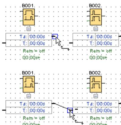
La línea de referencia entre dos parámetros señaliza su relación de referencia. La línea de referencia puede borrarse para eliminar la referencia.
