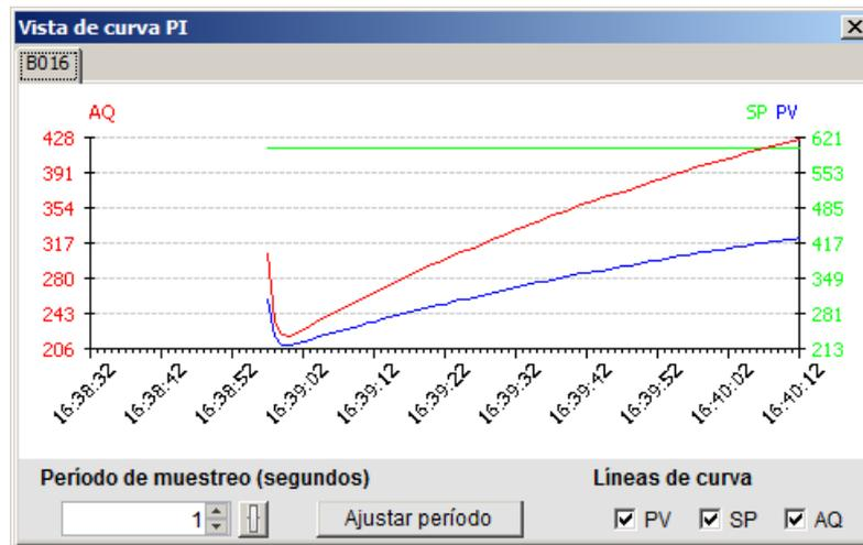
Si el programa contiene varios bloques de función de regulación, la vista de curva tendrá una ficha por separado para cada regulador.
