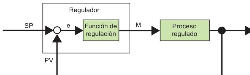
El elemento de comparación y la función de regulación describen el comportamiento del regulador.
