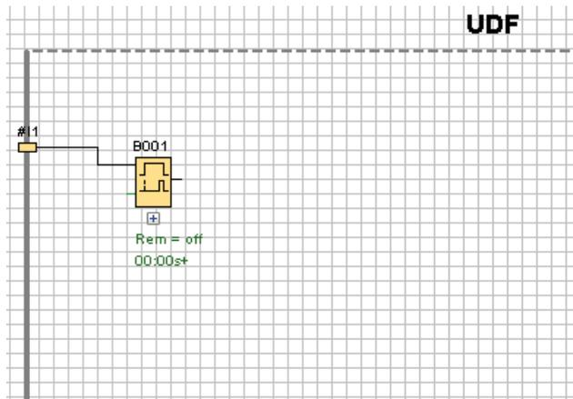
Para eliminar una entrada/salida, seleccione la figura del conector amarillo y elija "①" en el menú contextual. La o las líneas de conexión trazadas también se borran:
