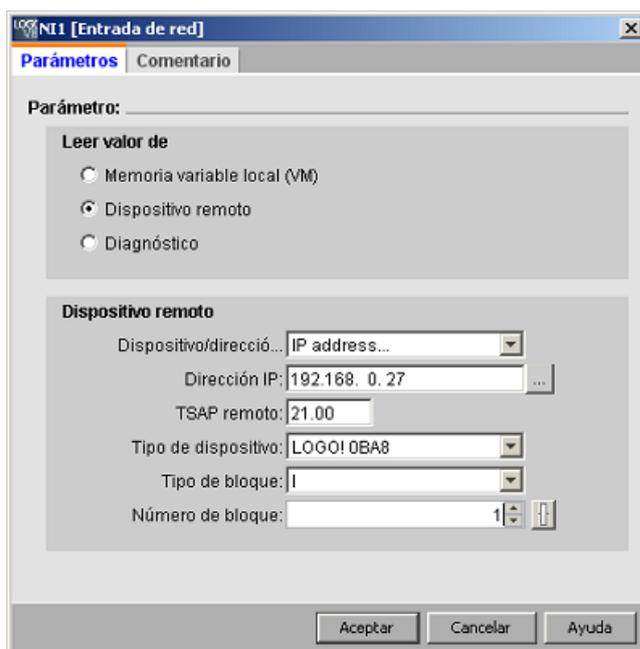
2. Ajuste el dispositivo para que se conecte como dispositivo remoto.
