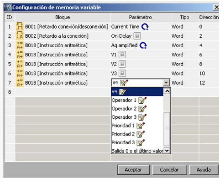
La columna "Bloque" lista los parámetros para SFBs en el programa actual. La columna de parámetros ofrece una lista de selección de los parámetros del bloque correspondiente. La columna de tipo muestra el tipo de datos del parámetro seleccionado. La columna de direcciones también es configurable. Se usa para identificar la dirección VM utilizada para guardar el valor de un parámetro.
