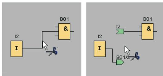
Si está activada la herramienta "Deshacer/unir conexión" y hace clic en un extremo abierto, se volverá a cerrar la conexión. Alternativamente, puede cerrar la conexión haciendo clic con el botón derecho del ratón en un extremo abierto y eligiendo el comando de menú **Unir conexión**.
