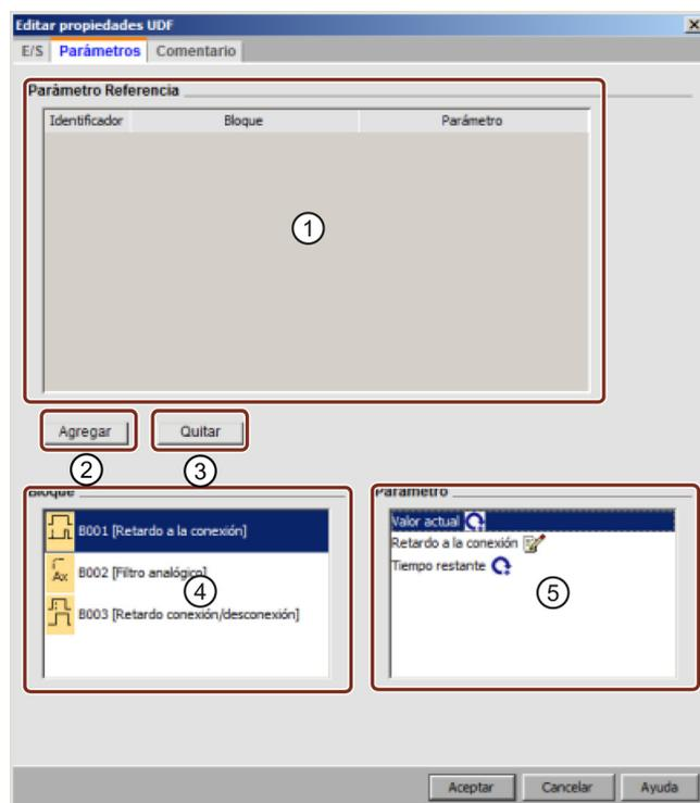
Los parámetros disponibles en los bloques de función utilizados en la UDF se pueden tomar como referencia para definir los parámetros de la UDF. "④" muestra los bloques de función, mientras que "⑤" muestra los parámetros incluidos en el bloque seleccionado. Haga doble clic en un parámetro o utilice "②" para mover un parámetro de "⑤" a "①":
