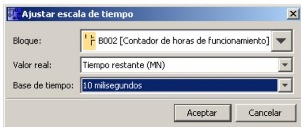
En este cuadro de diálogo se puede configurar la escala de tiempo para el valor de un bloque de función. Para ello, seleccione un bloque de función, un valor real y una base de tiempo y luego haga clic en "Aceptar" para confirmar los ajustes.
