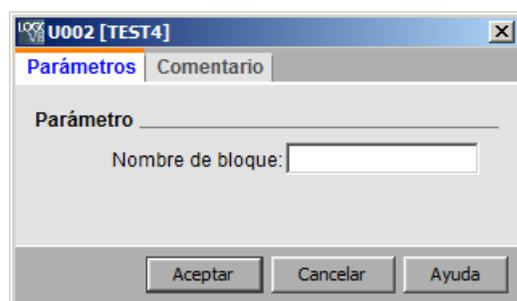
De forma similar, otros bloques pueden hacer referencia a parámetros UDF; así, por ejemplo, es posible arrastrar el conector de entrada del cuadro de diálogo de parámetros de un bloque de función hasta el conector de salida del cuadro de diálogo de parámetros de un bloque UDF:
