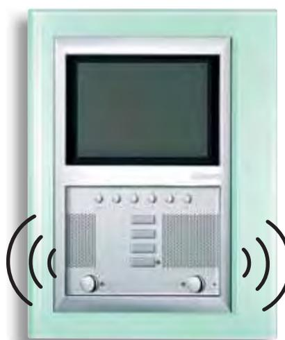
El puesto interno llamado empieza a sonar (con la sonería seleccionada para intercomunicación).
